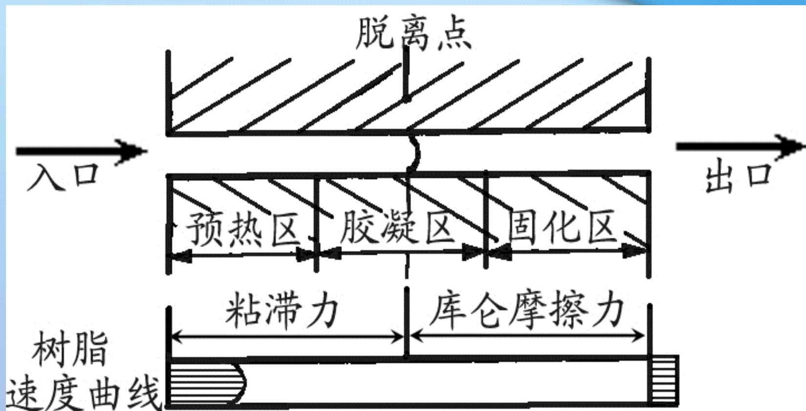
拉挤模具内树脂的速度曲线和不同区域的粘滞力和摩擦力示意图
